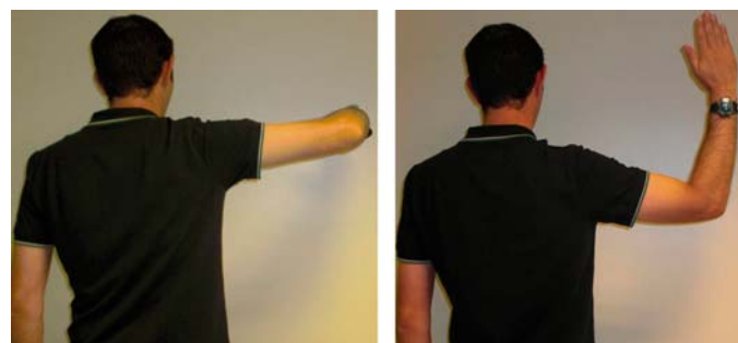
Figure 14. Dispositif d'enregistrement du déplacement angulaire du membre supérieur. Le capteur est placé au poignet et permet l'enregistrement de l'amplitude de rotation en R2.
